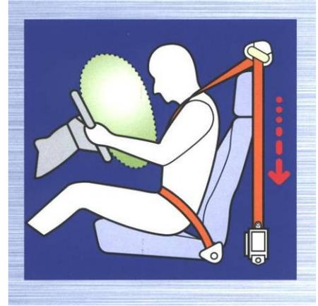
Die vorderen Airbags sind so konstruiert, dass sie sich nur bei einem schweren Frontalaufprall, in einem bestimmten Winkel, aufblasen.
