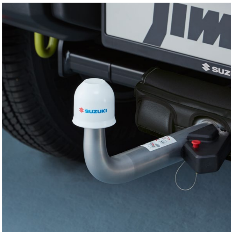
Art.-Nr. 72901-78R01-000 Für Anhänger und Trägersysteme. Max. Anhängelast: 1.300 kg. Max. Stützlast: 75 kg. E-Satz bitte separat bestellen.
